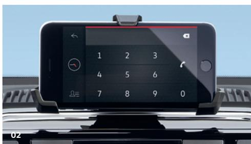
**02 Telefono.** Dispone della funzione vivavoce tramite Bluetooth® e accesso a tutti i contatti memorizzati sul proprio smartphone.
