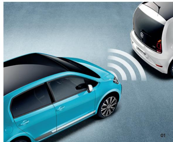
01 Grazie a un sensore laser, con una portata fino a 10 metri, il "City Emergency Brake" si attiva automaticamente per velocità fino ai 30 km/h.
