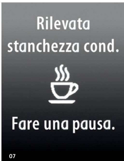
07 Il sistema di rilevazione della stanchezza "Fatigue Detection" sorveglia, tramite appositi sensori, il comportamento di guida del conducente, in modo da riconoscere i primi sintomi di un calo generale dell'attenzione. Quando il sistema rileva uno stato di stanchezza critico, suggerisce di fermarsi per una pausa tramite l'emissione di segnali visivi e acustici. | s
