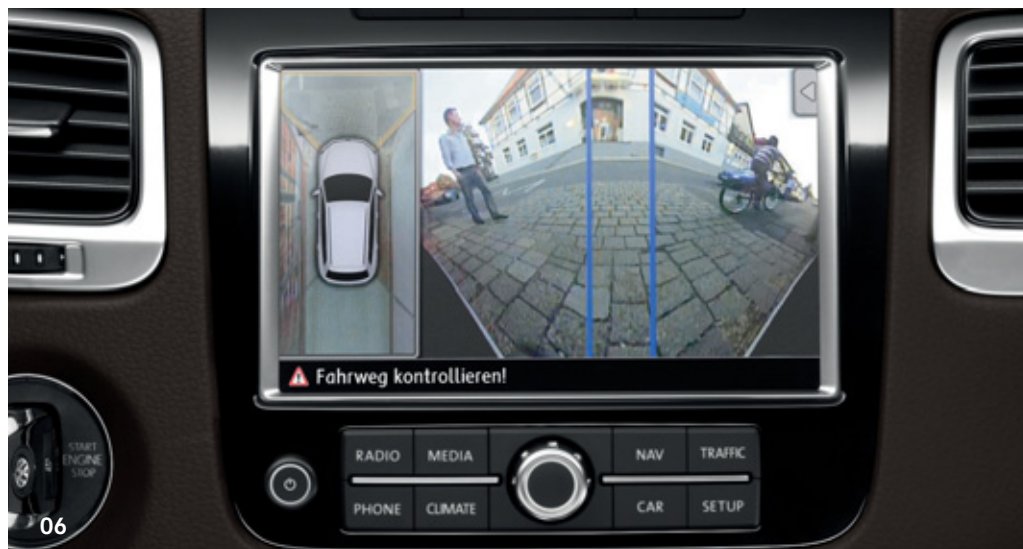
06 Sistema "Area View" visualizza in tempo reale immagini aeree della zona circostante la vettura con viste e prospettive diverse, eliminando gli angoli ciechi e permettendo di controllare la presenza di eventuali ostacoli sulla strada. | o
