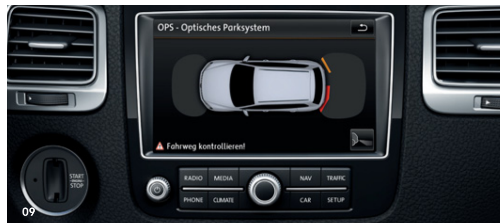
09 Il Park Pilot riporta sul display una rappresentazione grafica della prossimità agli ostacoli, emettendo avvisi acustici quando ci si avvicina progressivamente ad essi. | s
