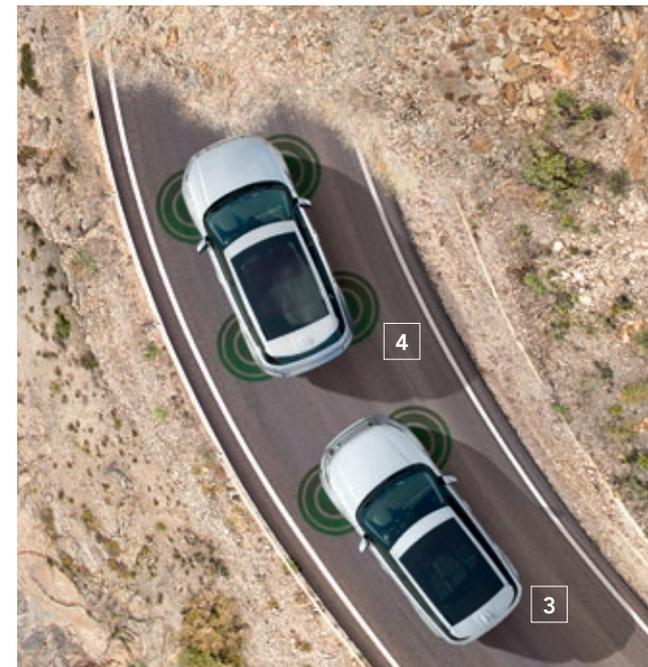
Se diventa necessaria la trazione integrale (4WD) il sistema la riattiva in 300 millisecondi, in modo impercettibile. Fuoristrada, la coppia di ogni ruota posteriore può variare secondo il grip. Un display sul Touch-screen ti aggiorna costantemente sulla situazione, per il massimo controllo.
