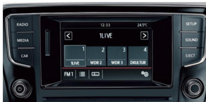
La radio **"Composition Colour"** con display touchscreen a colori da 5" e sei altoparlanti, lettore CD in grado di supportare i formati MP3 e WMA, è dotata di uno slot per schede SD e di una presa AUX-IN. [C]
