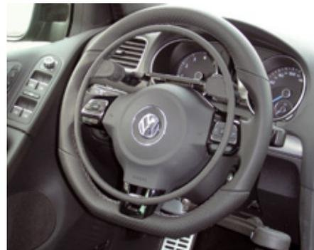
Acceleratore elettronico a cerchio sopra il volante di tipo sfilabile e freno di servizio a leva.
