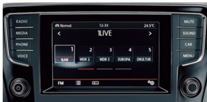
La radio **"Composition Media"** è dotata di display TFT a colori da 6,5", touchscreen con sensori di prossimità e lettore CD in grado di supportare i formati MP3 e WMA con sei altoparlanti. Il sistema dispone di uno slot per schede SD, una presa AUX-IN, un'interfaccia USB e un collegamento Bluetooth® per telefoni cellulari. [H]
