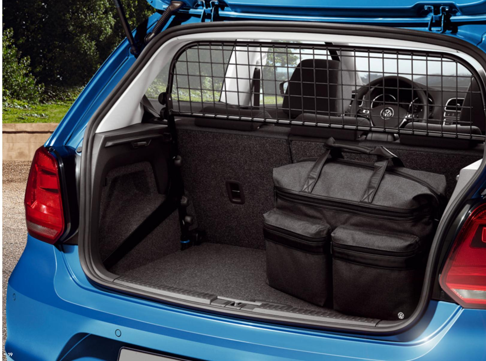
**18** L'**inserto antiscivolo per bagagliaio** è tagliato per adattarsi perfettamente alla forma del vano bagagli, proteggendolo efficacemente da sporco e umidità. In caso di non utilizzo può essere arrotolato e riposto in poco spazio. **Codice 6R0 061 160** per Polo con piano di carico base
