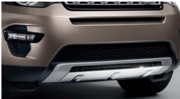
Piastra di protezione sottoscocca anteriore in acciaio inossidabile
