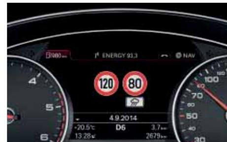
**Indicatore del limite di velocità con telecamera<sup>1,2</sup>**
