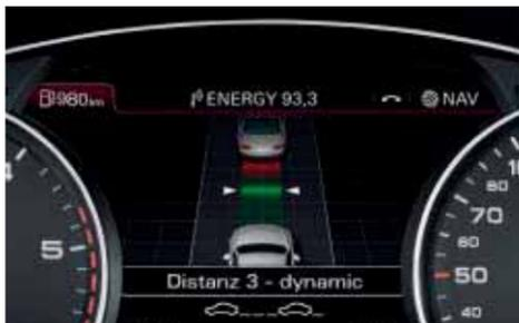
**Adaptive cruise control con funzione Stop&Go e Audi pre sense front<sup>1</sup>**
